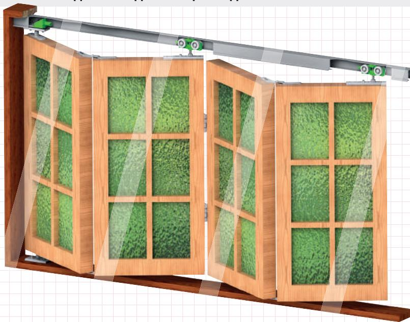
MKK 2B Katlanır Kapak Sistemi bir dolapta maksimum 40 kg. Ağırlığında kapak uygulanır. Kapak kalınlığı 22-40 mm arasında olmalıdır.
