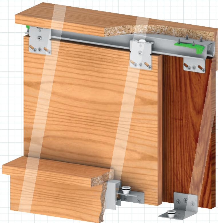
SKM 20-43 Hafif Sürgülü Kapak Sistemi bir dolapta Max.25 kg ağırlığında kapak uygulanır. Kapak kalınlıkları 16 - 18 - 22 mm arasında olmalıdır.
