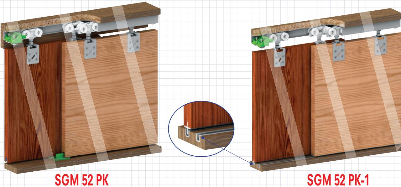
SGM 52 PK Sürgülü Kapak Sistemi bir dolapta maksimum 60 kg. Ağırlığında kapak uygulanır. Kapak kalınlıkları 16-18-22 mm arasında olmalıdır.
