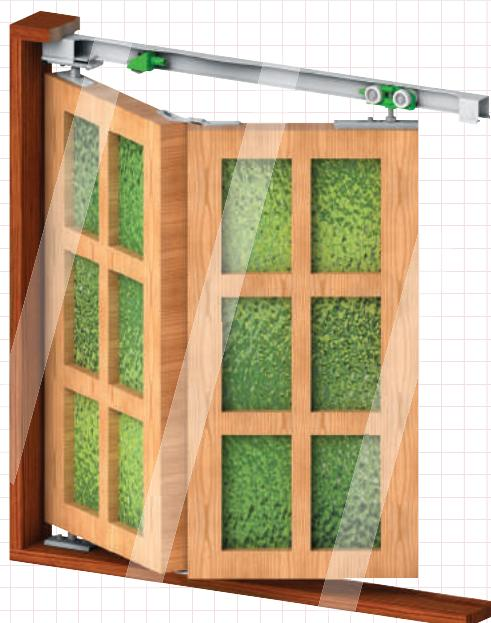
MKK 2A Katlanır Kapak Sistemi bir dolapta maksimum 25 kg. Ağırlığında kapak uygulanır. Kapak kalınlığı 22-40 mm arasında olmalıdır.
