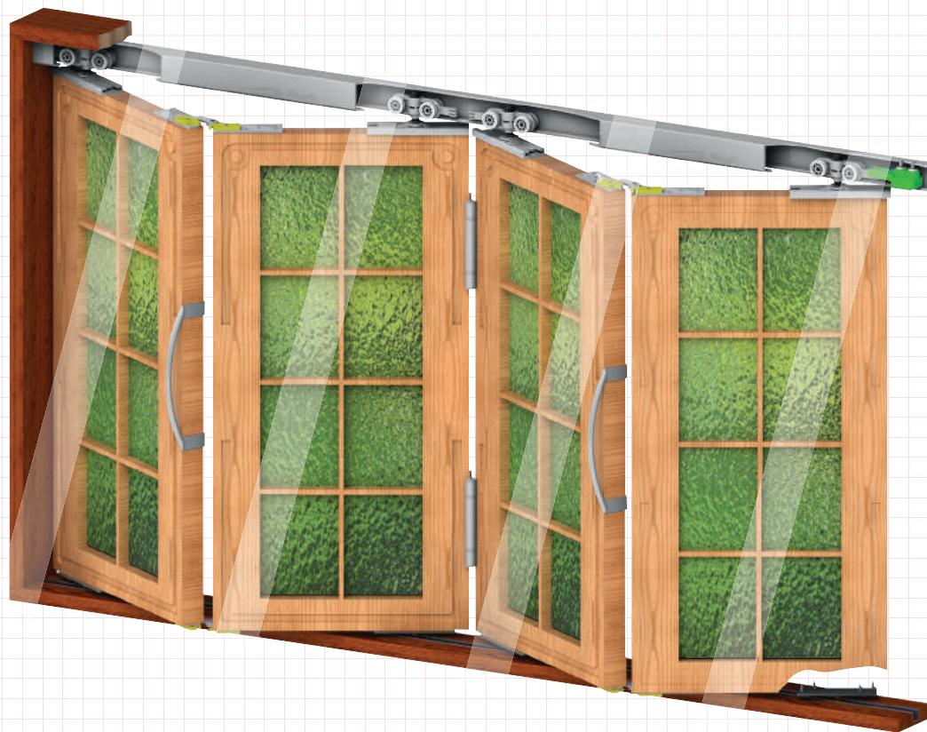
SKS 100-2B Katlanır Kapak Sistemi bir dolapta maksimum 100 kg. Ağırlığında kapak uygulanır. Kapak kalınlığı 22-40 mm arasında olmalıdır.
